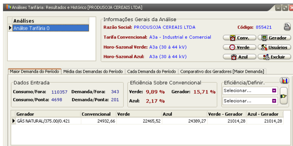
Figura 1.4 – Análise feita utilizando-se gerador a gás natural no horário de ponta
