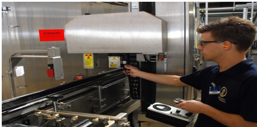
Figura 10 - Realização do teste de fuga de radiação do cabeçote
