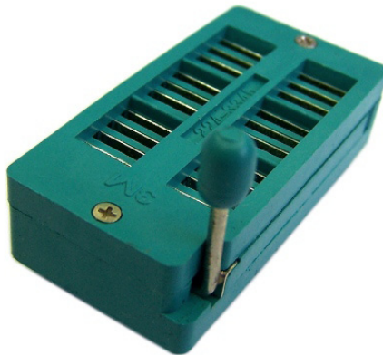
Figura 11 - Soquete ZIF utilizado para colocação do PIC 16F628A
