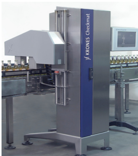
Figura5 - Equipamento de Inspeção de Nível
