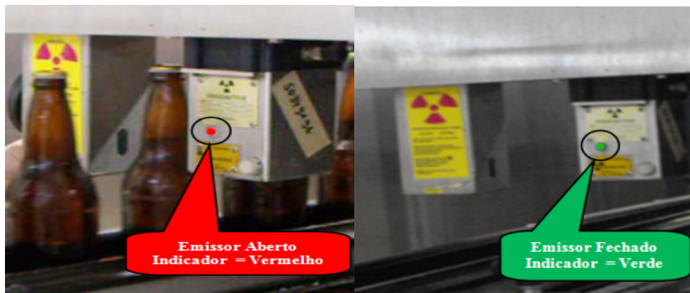
Figura 12 – Ímã Elevador do emissor aberto Figura 13 - Ímã elevador do emissor fechado
