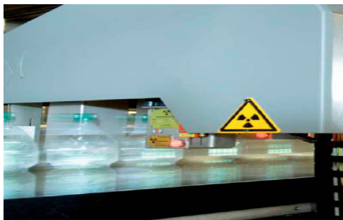
Figura 4 - Inspeção de Nível do Líquido Fonte: Krones Checkmat, 2011
