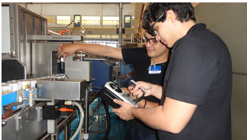
Figura 11 - Realização do levantamento radiométrico em equipamento de raios-X industrial
